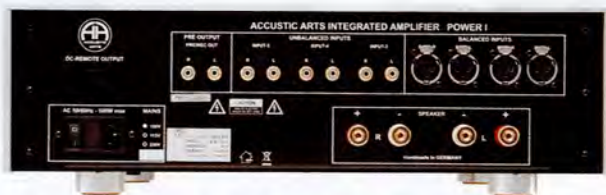
POWER Iの背面部。アナログ入力はRCA×3とXLR×2を装備する。スピーカー出力端子は1系統
