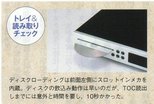
ディスクローディングは前面左側にスロットインメカを内蔵。ディスクの読み込み動作は早いのだが、TOC読み出しまでは意外と時間を使い、10秒かかった。
