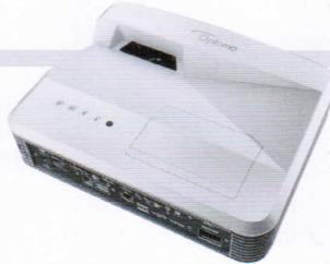
オプトマが、超短焦点DLPプロジェクターEH320USTを発売した。0.65型DC3のDMDパネルを採用し、本体内部の鏡に映像を反射させて超短焦点を実現したモデルだ。解像度は1,920×1,080画素。輝度は4,000ルーメン、コントラスト比は20,000:1となる。投写距離は100インチで31cmと驚異的に短い。3D表示にも対応し、DLP Link方式とVESA 3D方式に対応している。HDMI入力2系統を備え、ブルーレイ3Dの表示も可能。実勢価格は21万円前後
