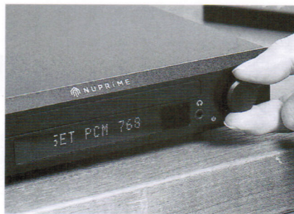
「サンプルレートコンバーター機能」を搭載するCDP-9。つまみ操作で、サンプリングレートを希望の値にアップサンプリングまたはダウンサンプリングすることができる（PCMは最大768kHz、DSDは最大22.6MHzまで）
