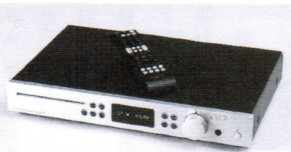
「サンプルレートコンバーター機能」を搭載するCDP-9。つまみ操作で、サンプリングレートを希望の値にアップサンプリングまたはダウンサンプリングすることができる（PCMは最大768kHz、DSDは最大22.6MHzまで）
